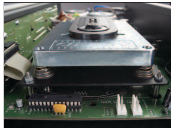
Die Aufhängung des Laufwerks ist ausgeklügelt und entkoppelt Schwingungen wirkungsvoll
