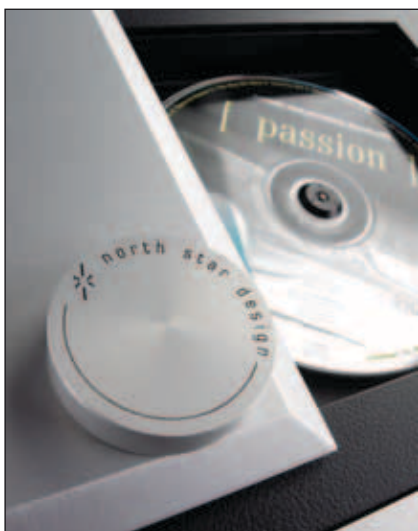
Die Toploader-Schublade geht schön sanft auf, das Laufwerk ist leicht schwingungsgedämpft
